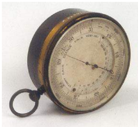
Exemplo de Barômetro Metálico.
