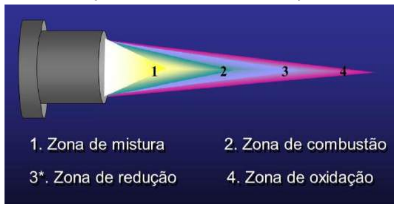
Figura 6. Zonas da chama do maçarico
