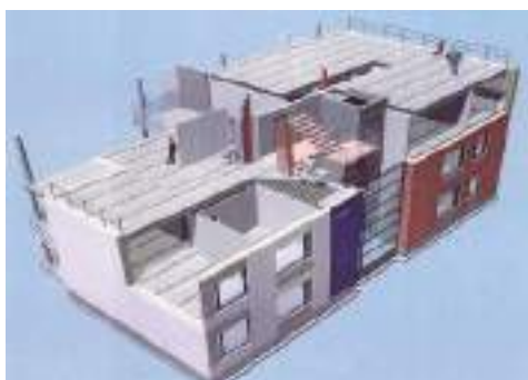
Figura 75: Sistema estrutural com painéis portantes e lajes alveolares protendidas (Fonte: FIB, CEB-FIP, 2002)
