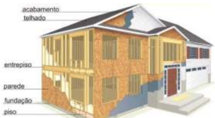
Figura 88: Perspectiva dos subsistemas que compõem a edificação construída no Sistema Plataforma (Fonte: Velloso, 2010)
