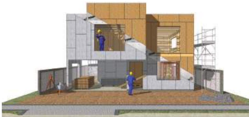
Figura 91: Vista de uma habitação de alto padrão executada em wood frame no Brasil
