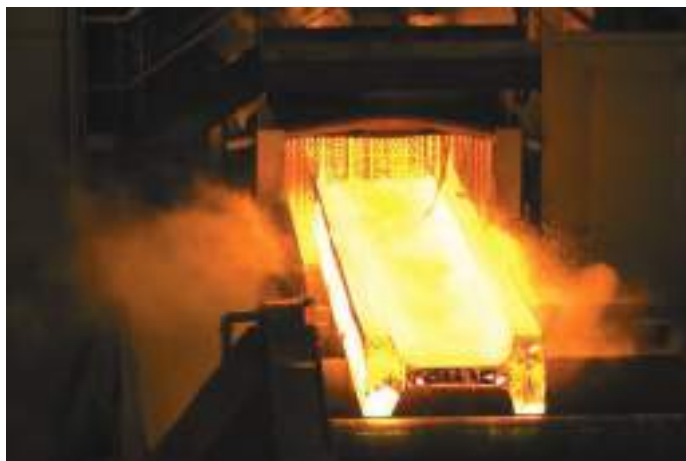
Figura 22: Processo de laminação; pode-se observar o esboço do perfil (Foto: associada CBCA)
