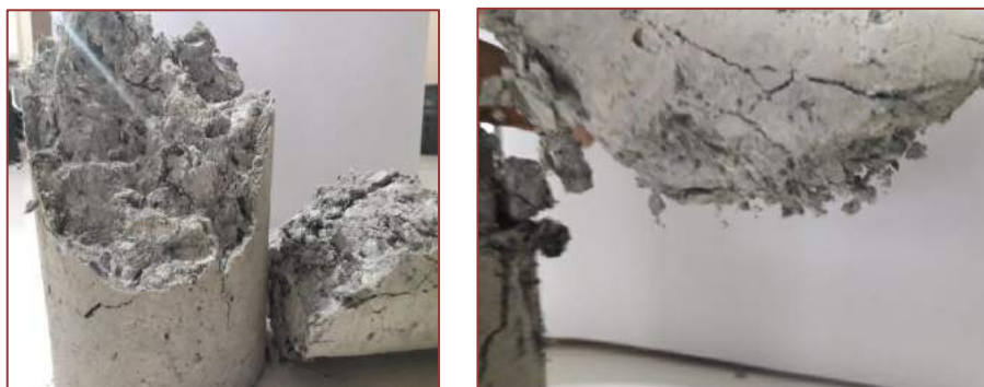
Figura 7: Corpo de prova com adição da FP rompido aos 28 dias
