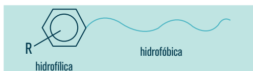
Figura 5.3 – Exemplo de molécula anfífilica – fórmula geral dos compostos derivados do alquil-benzeno, em que o grupo lateral pode ser R = -OH, -OR', -COOR'' , entre outros.
