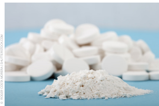
Figura 4.1 – Sólido – sob a forma de um pó fino e em porção inteira. A reação será mais rápida na forma de pó, pois haverá maior área superficial específica.
