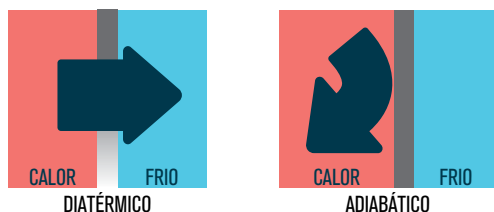
Figura 2.3 – Uma parede diatérmica permite a passagem de energia como calor. Uma parede adiabática não permite tal passagem.
