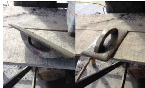
Figura 84- Desempoladeira de madeira, ferramenta utilizada para desempolar superfícies
