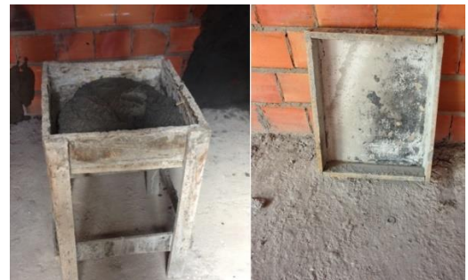
Figura 200- Tinas de madeira feitas em obra
