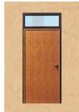
Figura 31- Porta com bandeira superior em vidro
