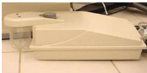
Figura 97: Unidade de abastecimento de água.
