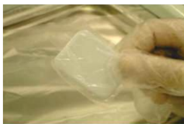
114: Filme radiográfico protegido por película de PVC.
