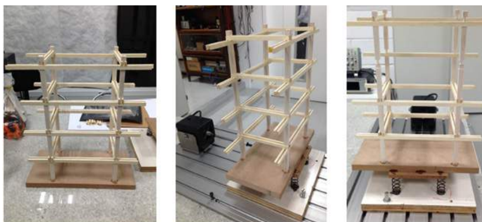
Figura 8: Aspectos do modelo físico antes as vibrações e o modelo com pontos colapsados entre o 2o pavimento e o pavimento de cobertura.
