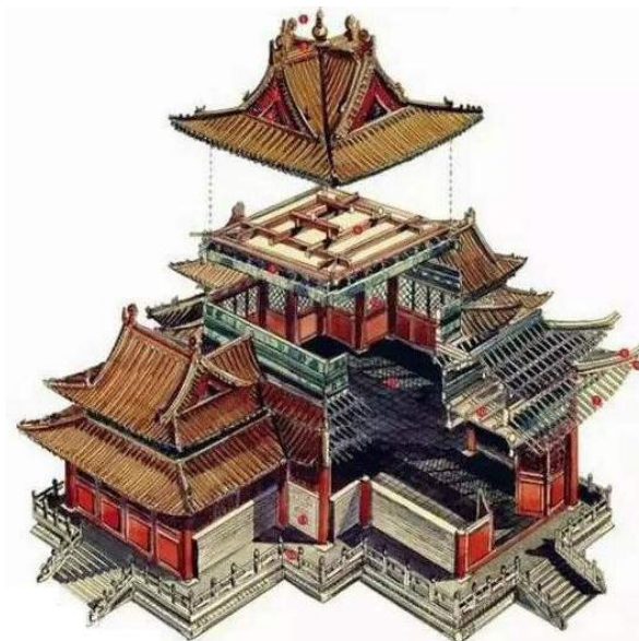
FIGURA 12: Representação de um exemplar da arquitetura da China Antiga com sua estrutura explodida, que permite uma melhor visualização de encaixes e da espacialidade interior.
