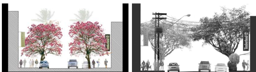
Figura 3. Comparação entre situação com postes e cabeamentos aéreos antes do projeto e situação posterior com sistema subterrâneo de redes e cabos.
