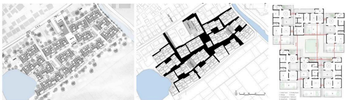
FIGURA 24: Desenhos técnicos do projeto. Da esquerda para a direita: planta de implantação geral, planta baixa geral do nível térreo e planta baixa do nível térreo de um setor ampliado, que mostra a relação entre seis blocos de habitação e o pátio compartilhado.
